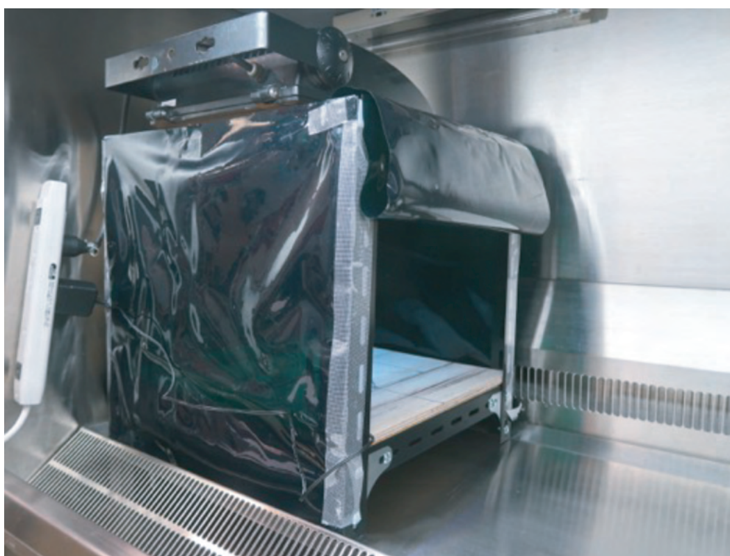
LED 照射実験装置
