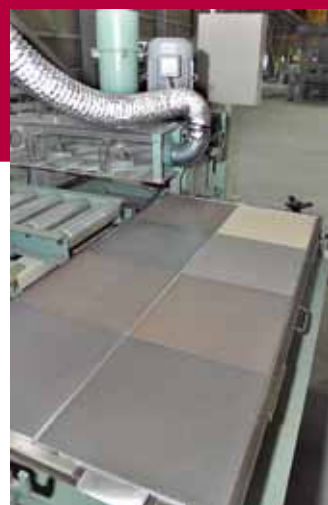
溶射後、洗浄、乾燥される光触媒タイル
