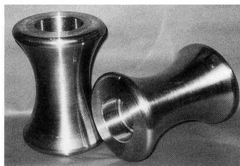
図-6 鋼管テストールの外観
