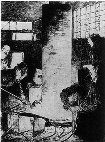
図-5 回転降下式鋳掛け肉盛溶接作業
