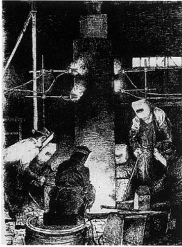
図-3 回転降下式肉盛溶接作業
