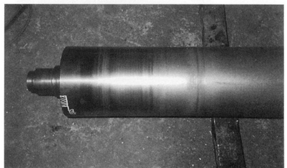
図-3 繰り返し衝撃による疲労摩耗の例
