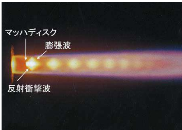
図8 HVOF 溶射ガンのフレーム中の衝撃波
