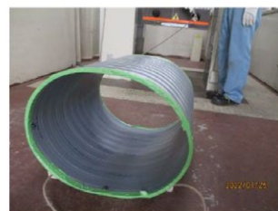
図 .8 100mm 偏平後試験体
